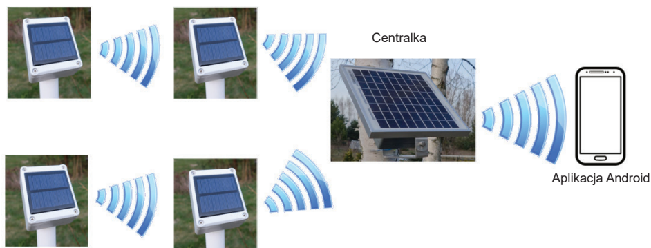
Rys. 17. Schemat systemu Aquastatus
