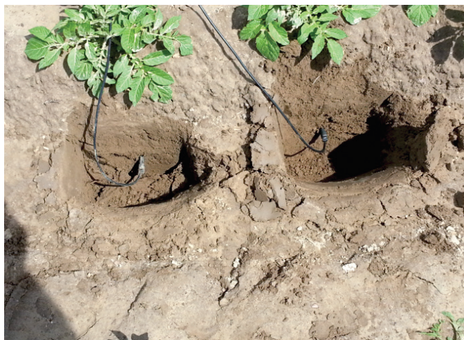
Rys. 8. Czujniki zainstalowane na stałe w strefie korzeniowej ziemniaka (fot. R. Wawer)
