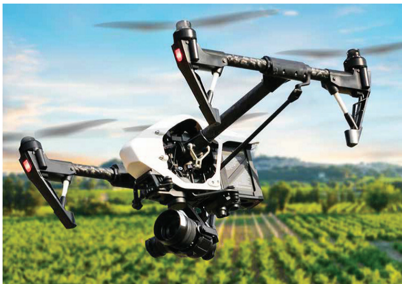
Rys. 4. Dron z kamerą multispektralną
